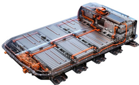
Fig. 63- Batería de alta tensión. NFPA-HEV-EV-Safety-Training-Student-Manual-1.0
