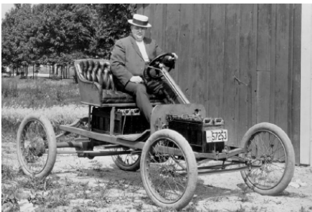
Fig. 4- Fred Allison, responsable técnico de la marca, al volante del prototipo de Ford eléctrico que desarrolló en 1914, con baterías de hierro-níquel ideadas por Thomas Edison. The Henry Ford
