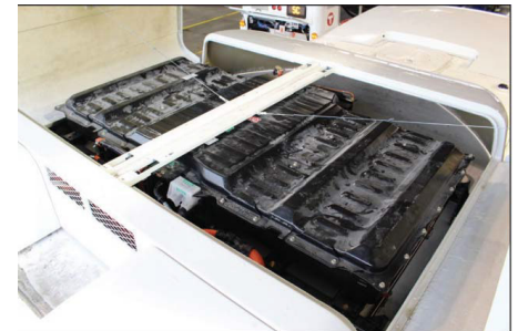
Fig. 35- Ubicaciones de las baterías HV en vehículo transporte de pasajeros NFPA-HEV-EV-Safety-Training-Student-Manual-1.0
