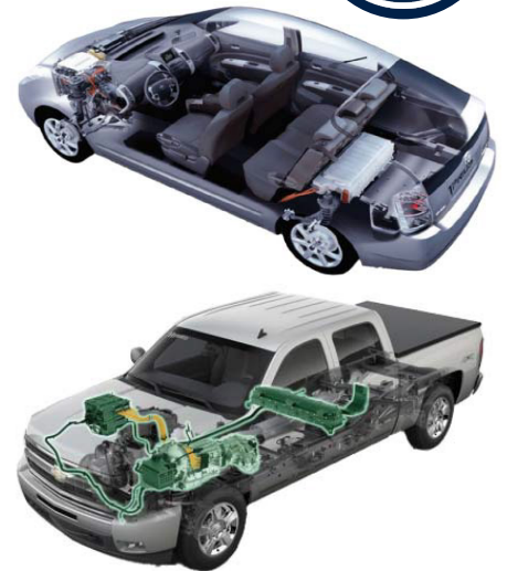
Fig. 32/33- Ubicación de baterías HV
