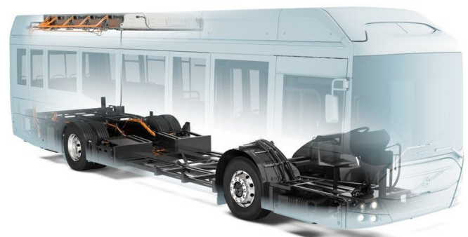
Fig. 40- Cableado interno- ubicación en buses eléctricos. https://www.hibridosyelectricos.com/autobuses/volvo-presenta-nuevo-chasis-autobuses-electricos_49664_102.html
