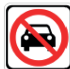
R-29 Circulación prohibida de vehículos automotores
